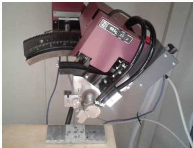
Рис. 3 Фотография гониометра и исследуемого металлоизделия.
